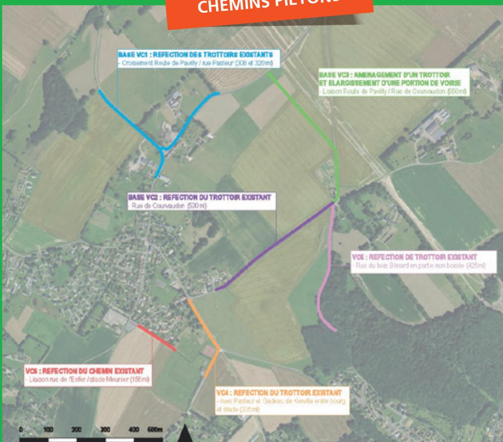
La commission cadre de vie a décidé d'un programme 2016 de réfection de la couche supérieure des chemins les plus enherbés qui sera réalisé à la rentrée scolaire. Les chemins seront revêtus d'un enrobé qui viendra remplacer le sable utilisé jusqu'à maintenant. L'enrobé permettra d'assurer leur usage pour les 20 prochaines années.
